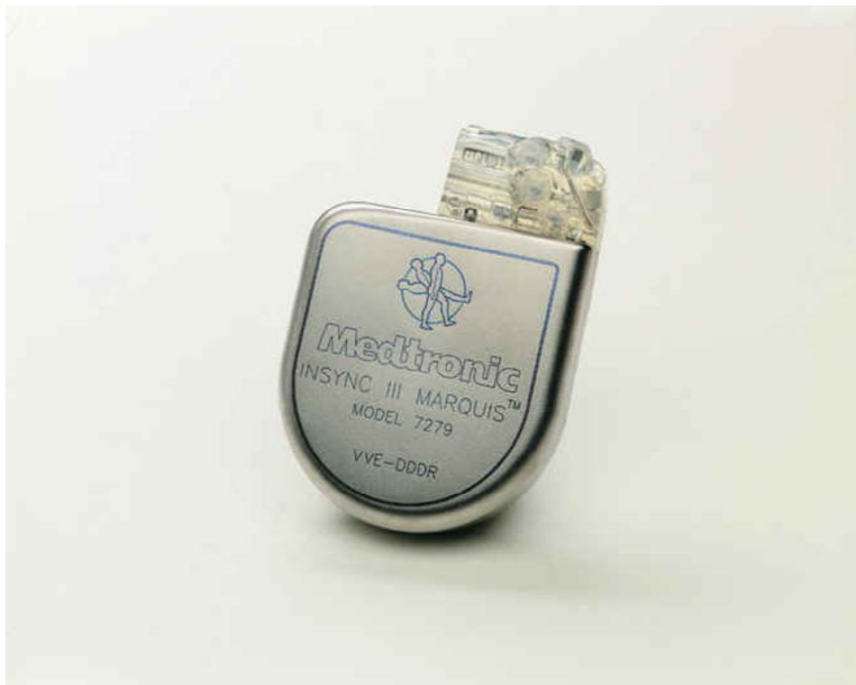
Abbildung 8 : biventrikulärer implantierbarer Cardiverter, Insync III Marquis, Fa. Medtronic
