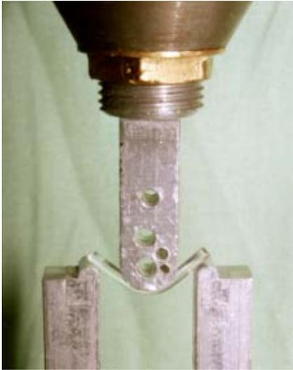
**Abbildung VI-10** Darstellung des Drei-Punkt-Biegeversuches an einem Bionx-Pin® bei einer Durchbiegung von 4 mm.
