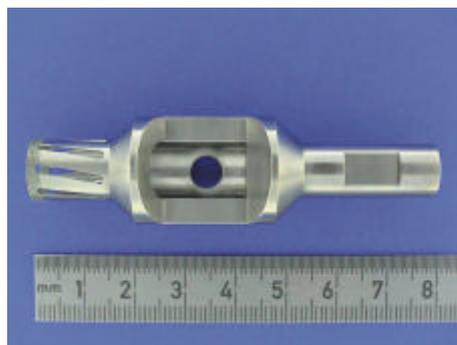
Der Hohlbohrer und somit die damit gewonnenen Knochenzylinder weisen einen Durchmesser von 10 mm auf. Auch der Bohrer wird während des gesamten Arbeitsschrittes mit isotonischer Natriumchlorid-Lösung gekühlt.
