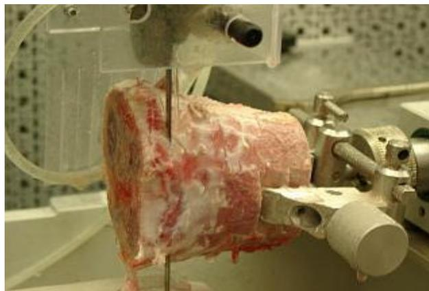
Im folgenden werden mit Hilfe der Bandsäge Knochenscheiben mit einer Dicke von 8 mm aus dem Präparat geschnitten. Das Sägeblatt der Bandsäge ist mit feinsten Diamanten besetzt und wird während des gesamten Sägevorganges mit einer auf 4°C temperierten isotonischen Natriumchlorid-Lösung gekühlt, um bearbeitungsbedingte Gewebedefekte so gering wie möglich zu halten.
