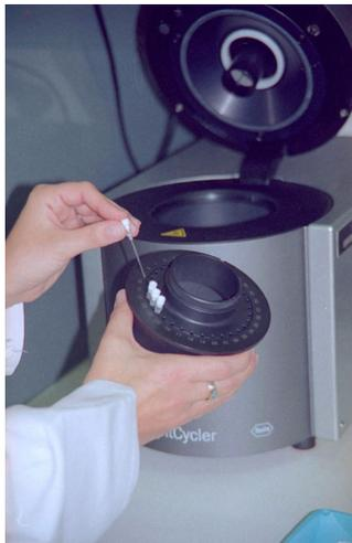
**Abb. 2.8** LightCycler der Firma Roche Diagnostics. Darstellung des LightCycler Karussells mit den Kapillaren, in denen die Reaktion stattfindet.
