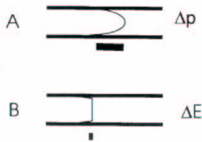
Abb.2: Vergleichende Abbildung eines durch Druckdifferenz verursachten Flußprofils (A) und eines elektrokinetisch erzeugten Flußprofils (B)
