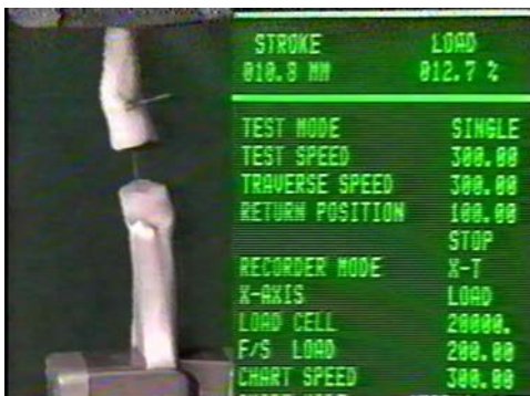
Abb. 34c: weiterer Verlauf von Dehnung/Kraft 10.8 mm / 12,7 % (25,4 N)
