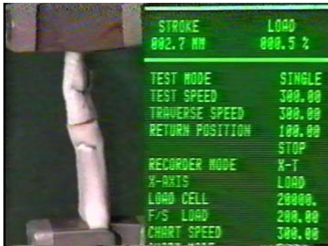
Abb. 34a: Dehnung/Kraft bei Spaltbildung 2,7 mm / 0,5 % (1,0 N)
