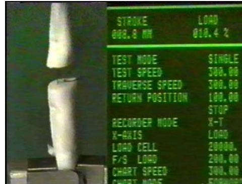
Abb. 36b: Dehnung/Kraft bei Nahriß 8,8 mm / 10,4 % (20,8 N)
