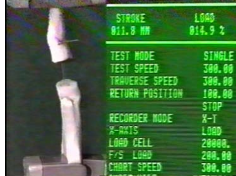
Abb. 34d: Dehnung/Kraft bei Nahtriß 11,8 mm / 14,9 % (29,8 N)
