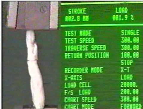
Abb. 35a: Dehnung/Kraft bei Spaltbildung 2,8 mm / 1,9 % (3,8 N)
