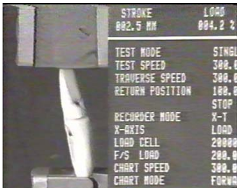
Abb. 40a: Dehnung/Kraft bei Spaltbildung 2,5 mm / 4,2 % (8,4 N)
