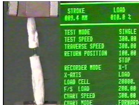
Abb. 35b: weiterer Verlauf von Dehnung/Kraft 9,4 mm / 10,0 % (20,0 N)
