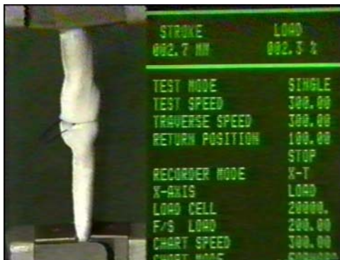
Abb. 33a: Dehnung/Kraft bei Spaltbildung 2,7 mm / 2,3 % (4,6 N)
