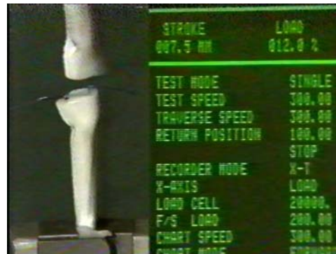
Abb. 38b: Dehnung/Kraft bei Nahriß 7,5 mm / 12,0 % (24,0 N)
