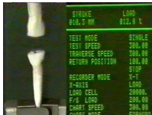
Abb. 33b: Dehnung/Kraft bei Nahriß 10,3 mm / 12,8 % (25,6 N)
