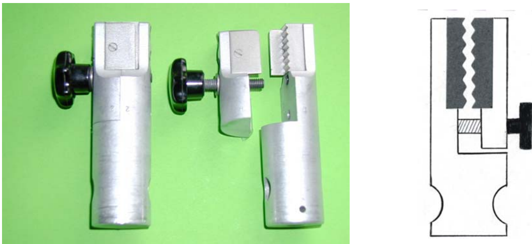
Abbildung 25: Foto und schematische Darstellung der an der Philipps-Universität entwickelten Sehneneinspannvorrichtung für den Shimadzu Autograph AG-2000A
