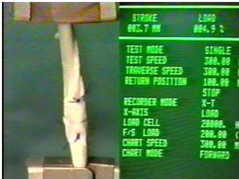
Abb. 42a: Dehnung/Kraft bei Spaltbildung 3,7 mm / 4,9 % (9,8 N)
