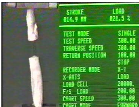
Abb. 35c: weiterer Verlauf von Dehnung/Kraft 14,9 mm / 21,5 % (43,0 N)
