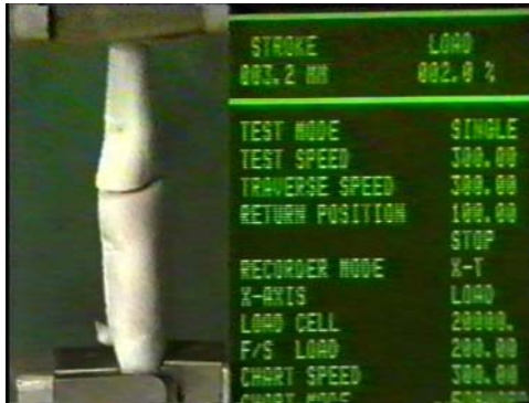
Abb. 36a: Dehnung/Kraft bei Spaltbildung 3,2 mm / 2,0 % (4,0 N)
