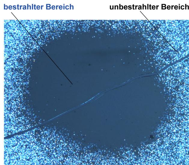
*Abb. 5-35: Lichtmikroskopische Aufnahme eines belichteten und thermisch entwickelten Films der Verbindung CZ 18 unter gekreuzten Polarisatoren.*
