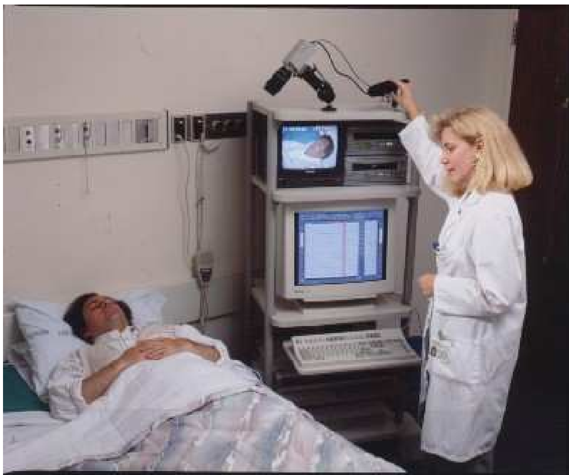
Abb. 2: Das computergestützte Video-EEG-Monitoring-System Vanguard® im Einsatz
