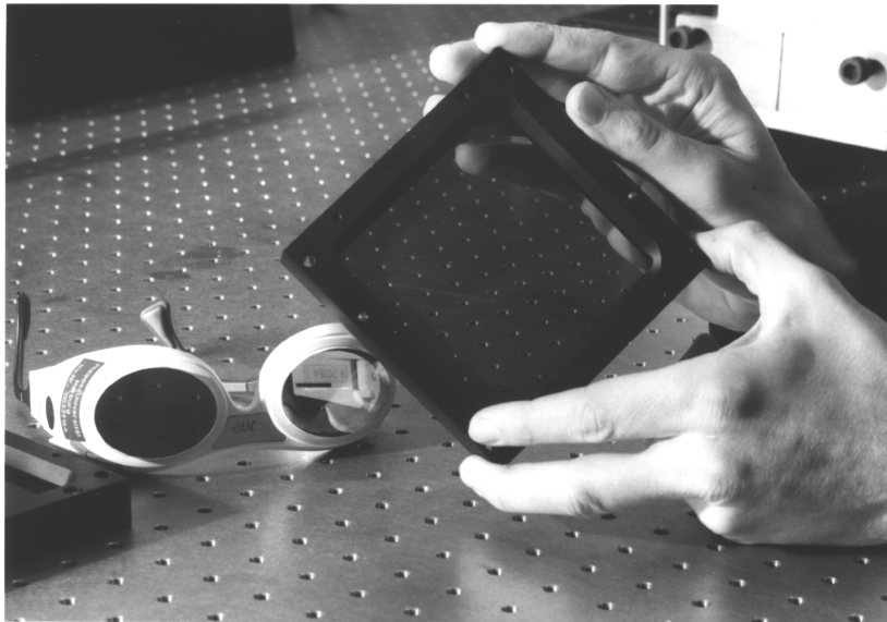
Abb. 34: BR-Film mit einer freien Apertur von 90 mm x 90 mm. Der Film hat eine Dicke von etwa 100 µm, ist von beiden Seiten mit einer Glasplatte geschützt und in eine Fassung mit Außendimensionen von 120 mm x 120 mm montiert.
