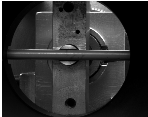
Abb. 36: Aufbau zur Deformation von Keramikventilen. Mit diesem Aufbau kann eine kontrollierte Kraft auf den Schaft eines Keramikventils erzeugt werden. Er wird in der Objektebene eines Interferometrieaufbaus plaziert.
