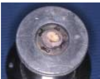
Abb. 7: Zahn im Probenhalter fixiert
