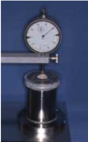
Abb. 6: Versuchsaufbau mit Probenhalter und Messuhr
