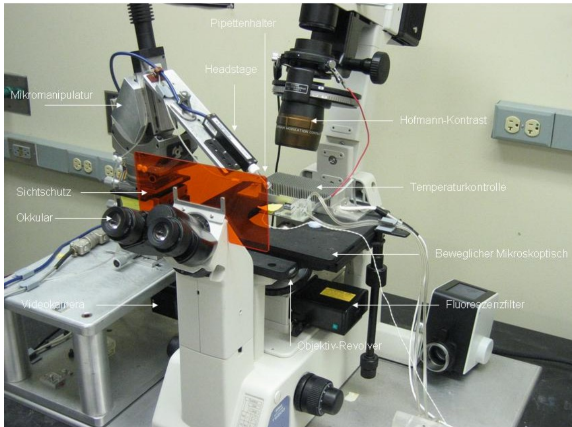
Abbildung. 11. Optische und mechanische Komponenten des „Patch-Clamp“-Standes
