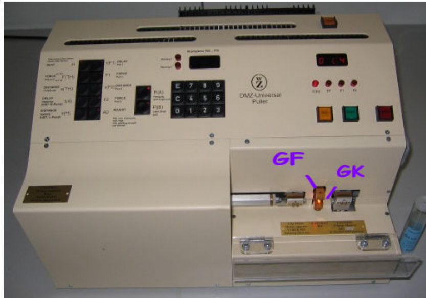
Abb. 2.7: DMZ Universal Puller. Die Herstellung von Pipettenspitzen aus einer Glaskapillare (GK) ist hier dargestellt. Das Glühfilament (GF) erhitzte die Röhrenmitte bis der Zug des Pullers die Kapillare auseinander riss und zwei Pipettenspitzen entstanden.
