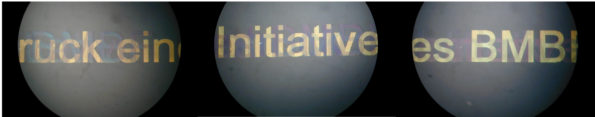
Abbildung 5.21: Photoaufnahme des beschriebenen BR-Films für die Datenspeicherung mit drei Informationen anhand der anisotropen Veränderung des Azimuth Winkels.
