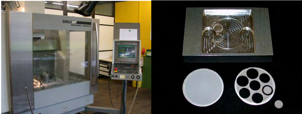
Abb.5.7: a) CNC-Fräsmaschine der Firma Deckel Maho, Modell DMU 50 T b) Einsatz für Fräsmaschine zur Positionierung der Template, im Vordergrund Templat (rechts) vor Bearbeitung und Templat nach der Fräsung (links) mit resultierenden Scheibchen
