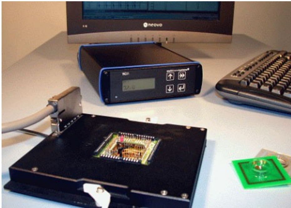
Abbildung 3.7 Mikroelektroden-Array (MEA): Messanordnung mit Verstärker (Abb. von Fa. Multi Channel Systems).
