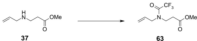
Abbildung 37: Darstellung der \text{COCF}_3 tragenden stickstoffführenden Komponente. Reagenzien und Reaktionsbedingungen: TFAA, TEA, DCM, 0 °C, 3 h, 88%.
