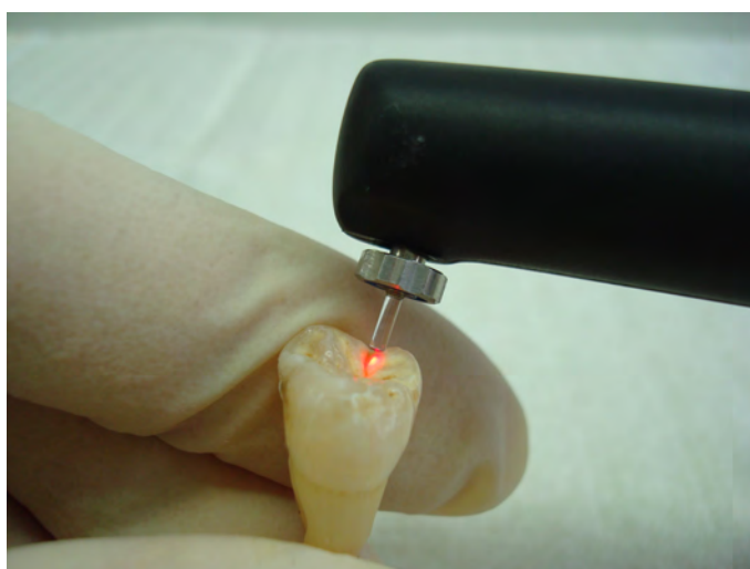
Abb. 4.8: Diagnodent Pen 2190 Sondenaufsatz zylindrisch während der Untersuchung
