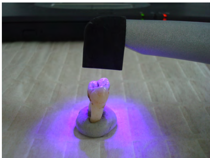
Abb. 4.10: Verwendung des langen Abstandhalters der VistaProof-Kamera
