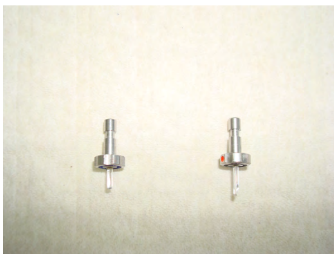
Abb. 4.7: Diagnodent Pen 2190 Sondenaufsätze zylindrisch und konisch
