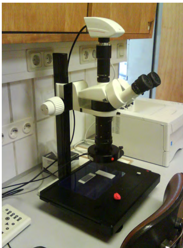
Abb. 4.1: Leica DFC Kamera mit Leica Z6 APO Mikroskopobjektiv
