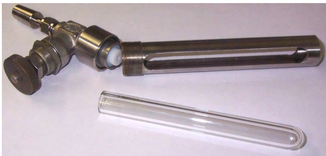
Abb. 315: Reaktor mit Glaseinsatz zur Synthese des \text{Ir}_4(\text{CO})_{12} . Das Reaktionsgefäß aus Duranglas (Außendurchmesser = 16 mm, Wandstärke = 2 mm, Länge = 140 mm) wird zur Umsetzung in den seitlich geöffneten Edelstahlmantel gesteckt und durch Aufschrauben des Ventilaufsatzes verschlossen. Den Abschluß des Glasreaktors bildet ein fest montierter, dicht schließender Tefloneinsatz.
