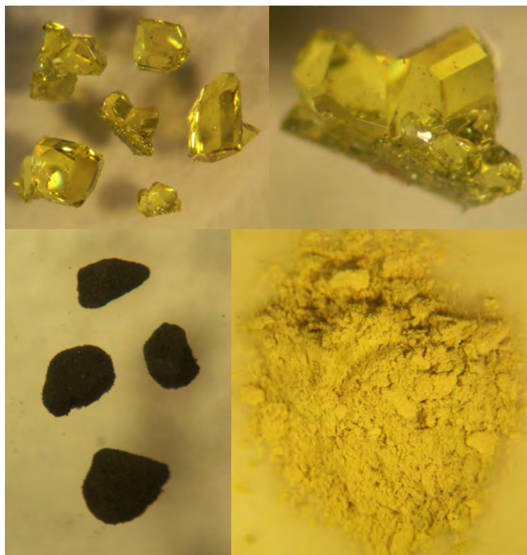
Abb. 318: Zur thermischen Zersetzung des \text{Ir}_4(\text{CO})_{12} : Kristalle des \text{Ir}_4(\text{CO})_{12} (oben), durch Sublimation und Kristallisation aus pulverförmigem \text{Ir}_4(\text{CO})_{12} (unten rechts) erhalten (dw03). Als Produkt der thermischen Zersetzung entstand außerdem Ir-Mohr (unten links; eine Verfeinerung der Gitterkonstante liefert ein in der Tendenz leicht vergrößerte Elementarzelle für diese Form des Ir: a = 384(1) pm). Die Größe der \text{Ir}_4(\text{CO})_{12} -Kristalle und der Ir-Partikel liegt in der Größenordnung von 0,1 bis 1 mm.
