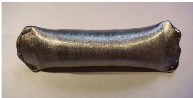
Abb. 257: Synthese des \text{Ir}(\text{Mg}_x\text{Zn}_{1-x})_3 und Präparation in Form eines aufgeschmolzenen Regulus – II ( x = 2/15 ; wh109). Abgebildet ist der gasdicht verschweißte Ta-Tiegel.
