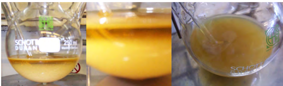
Abb. 316: Synthese des \text{Ir}_4(\text{CO})_{12} durch CO-Gaseinleitung in eine wässrig-ethanolische Suspension von \text{IrCl}_3 \cdot x\text{H}_2\text{O} (Methode III, [195]). Abgebildet sind eine Seitenansicht des Reaktionsgefäßes (links), eine Nahaufnahme in gleicher Blickrichtung (mitte), sowie eine Draufsicht des mit einem Gaseinleitungsrohr versehenen Dreihalsrundkolbens. Gezeigt ist hierbei der Synthesefortschritt nach sechsständigem Refluxieren und zwölfständigem Stehenlassen (bei konstantem CO-Gasstrom) und vor der Zugabe der wässrigen \text{Na}_2\text{H-Citrat} -Lösung ( c = 1 \text{ mol/l} ). Aus der klaren, bernsteinfarbenen Reaktionslösung sind bereits große Mengen des feinkristallinen, hellgelben \text{Ir}_4(\text{CO})_{12} ausgefallen.
