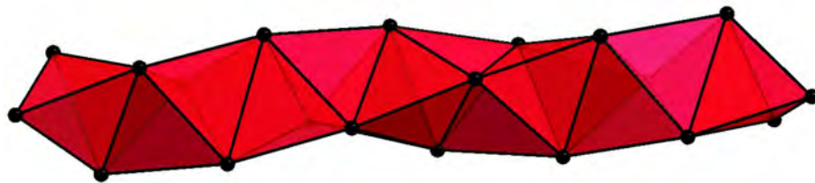
Abb. 61: Ausschnitt einer Boerdijk–Coxeter -Helix aus flächenverknüpften regulären Tetraedern.
