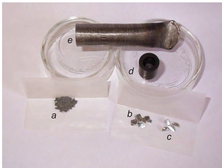
Abb. 256: Synthese des \text{Ir}(\text{Mg}_x\text{Zn}_{1-x})_3 und Präparation in Form eines aufgeschmolzenen Regulus – I ( x = 2/15 ; wh109). Abgebildet sind als Edukte mattgraues Ir-Pulver (a), in Stücke geschnittenes, silberglänzendes Mg-Band (b) und halbierte, silberglänzende Zn-Granalien (c), sowie ein Einsatz aus Glaskohlenstoff (d) und der umhüllende Ta-Tiegel (e). Die Umsetzung erfolgte im Gramm-Maßstab.
