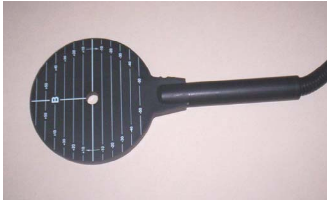
Abbildung 12: Rundspule MC 125 der Firma Dan-tec, Durchmesser 13 cm.
