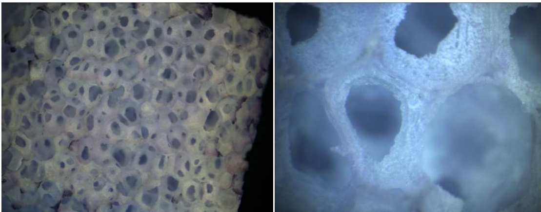
Abbildung 4: Elektronenmikroskopische Aufnahmen eines Scaffold „ coated and loaded “.
