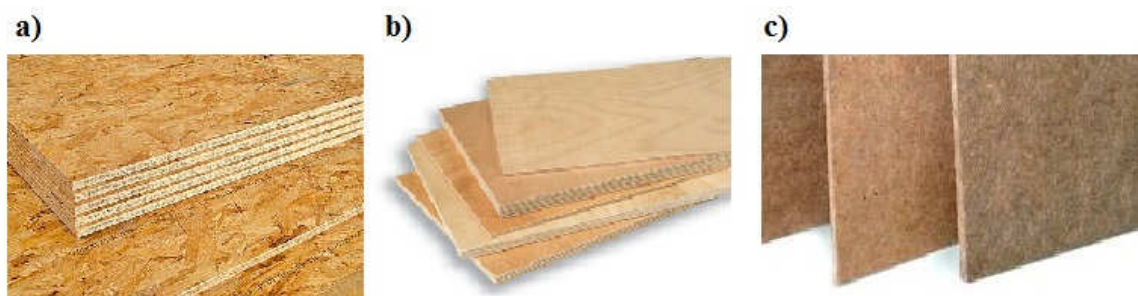
Obr. 12: Aglomerované dřevo: a) OSB desky, b) překližka, c) dřevovláknité desky [39]
