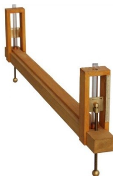
Fig. 1. Heron's levelling device (Kotsanas, K)
