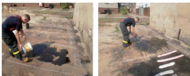
Obr. 5-6 Simulování úniku ropných produktů (m. olej, l. petrolej) na pevný povrch
