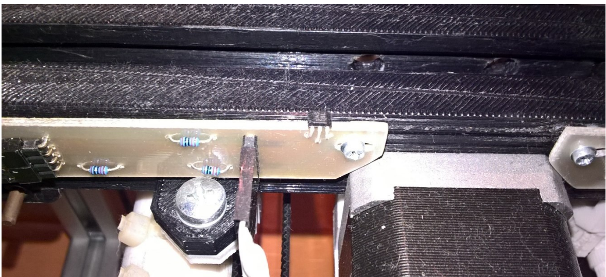
Obr. 5.14 Umístění Hallova snímače polohy
