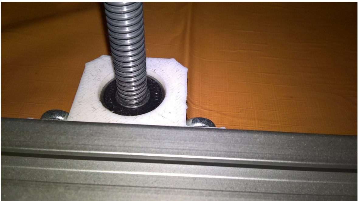
Obr. 5.4 Uložení pohybového šroubu v ložisku
