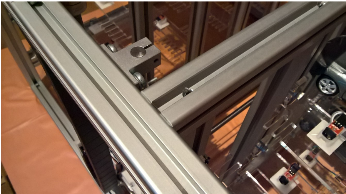
Obr. 5.2 Detail spojení profilů a upevnění vodicích tyčí
