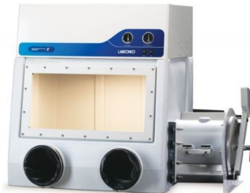
Obrázek č.3: Rukavicový box umožňující kontrolu atmosféry [12]
