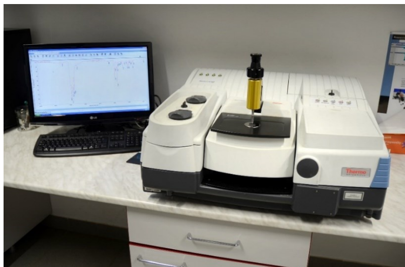
Obrázok 32: Infračervený spektrometer s Fourierovou transformáciou Nicolet 6700 FT-IR (Thermo Nicolet, USA) [32].
