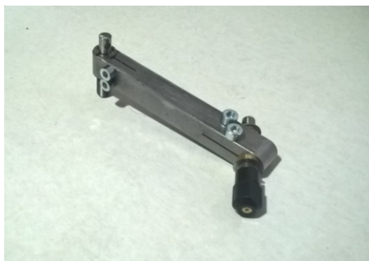
Obr 5.13 Multifunkční držák leštícího nástroje
