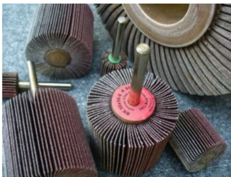
Obr. 4.5 Lamelové kotouče smirkové
