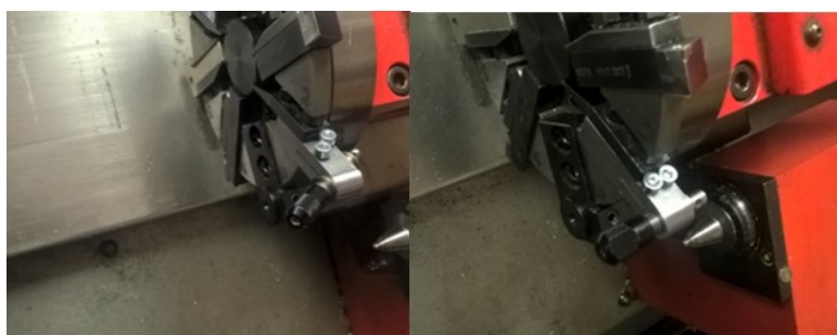
Obr 5.8 Úprava multifunkčního držáku
