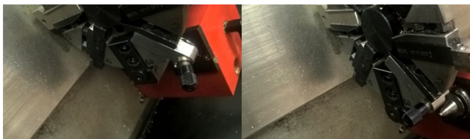
obr. 5.9 Multifunkční nástroj se zapuštěnými regulačními šroub
