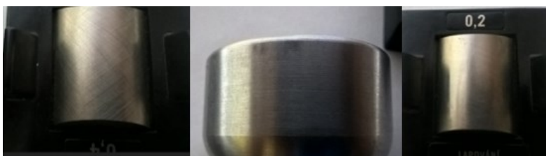
Obr. 5.14 Ukázka kontroly drsnosti povrchu
