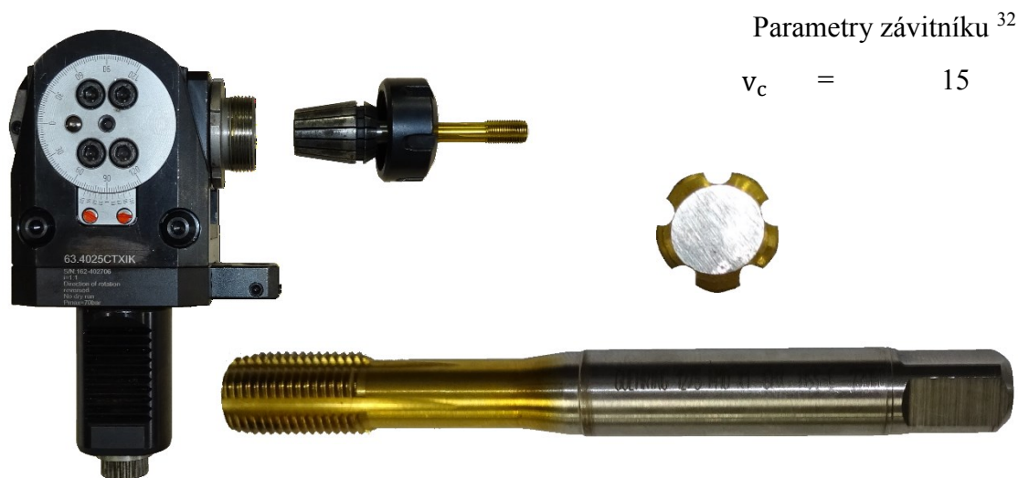
Obrázek 3.28 – sestava tvářecího závítníku – T7-I s detailem závítníku
