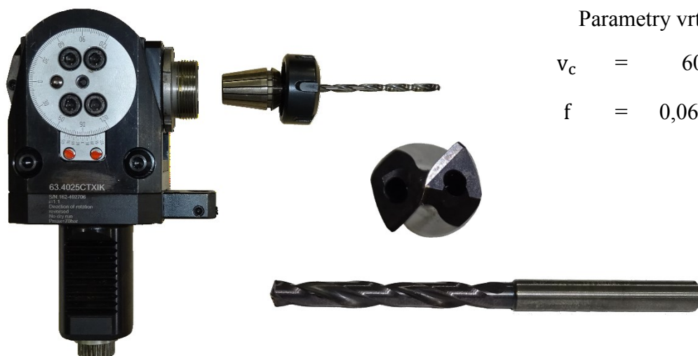
Obrázek 3.24 – sestava vrtáku D5 – L82 – T2-II s detailem vrtáku
