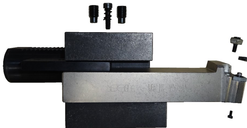
Obrázek 3.17 – sestava dokončovacího nože – T11-I
