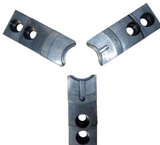
Obrázek 3.13 – speciální čelisti pro obrobený povrch
