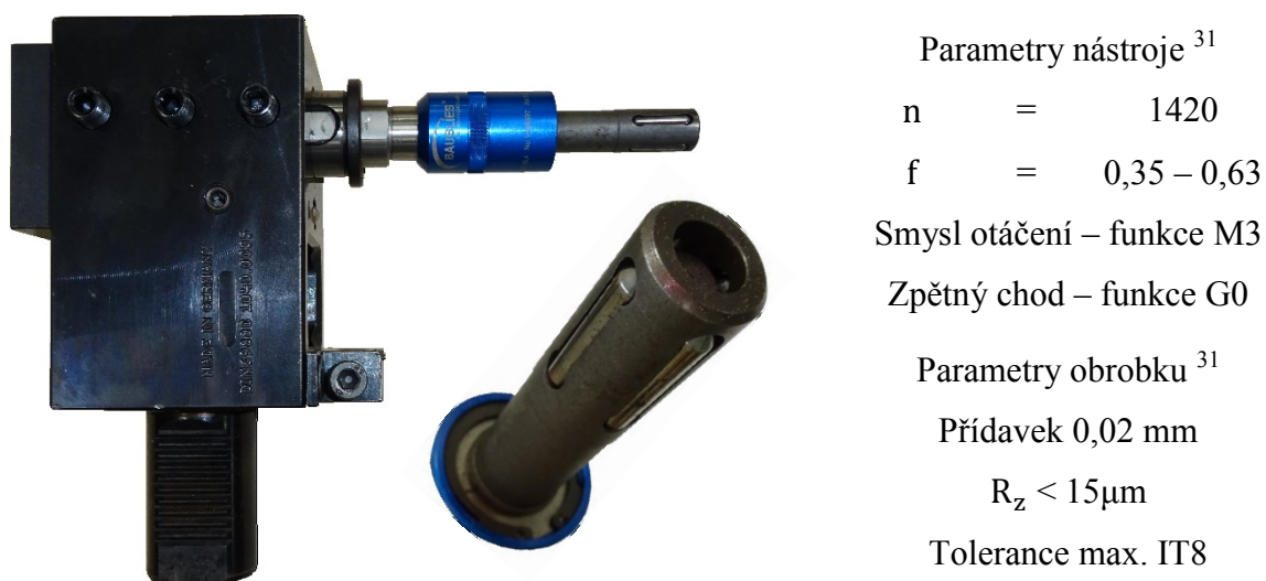
Obrázek 3.29 – sestava válečkovacího nástroje – T9-I s detailem válečkovacího nástroje
