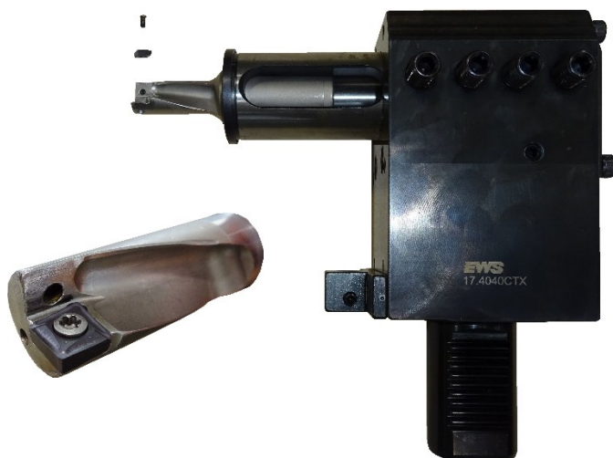
Obrázek 3.22 – sestava osového vrtáku D15 – T5-I s detailem vrtáku
