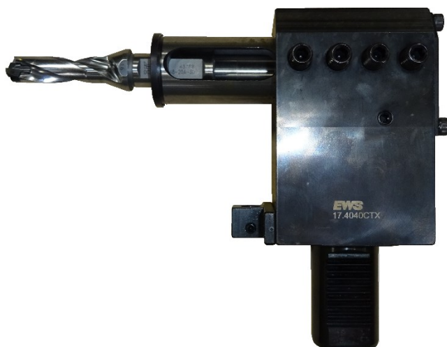
Obrázek 3.23 – sestava korunkového vrtáku D16,1 – T8-I s detailem vrtáku
