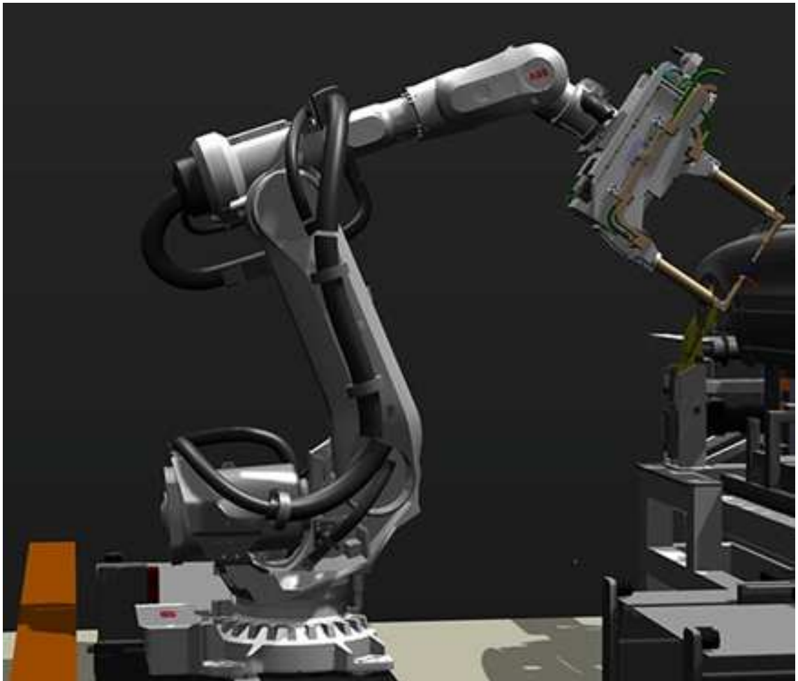
Obrázek 2 Robot s kleštěmi pro CNC bodové svařování [10]
