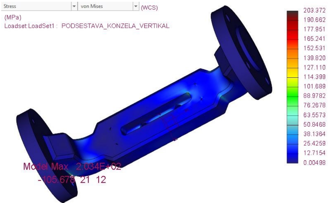
Obr. 78 Ekvivalentní napětí von-Mises na U-konzole vertikál pohled 2
