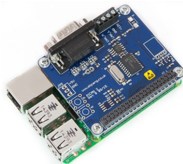
Obr. 109 CAN interface umístěn na řídicí jednotce
