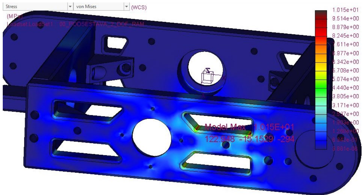
Obr. 64 Napětí von-Mises rámu 2DOF
