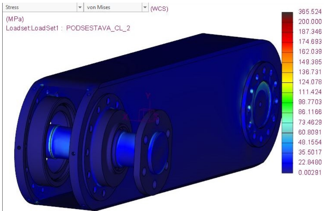
Obr. 83 Ekvivalentní napětí von-Mises na 2. článku ramene pohled 2
