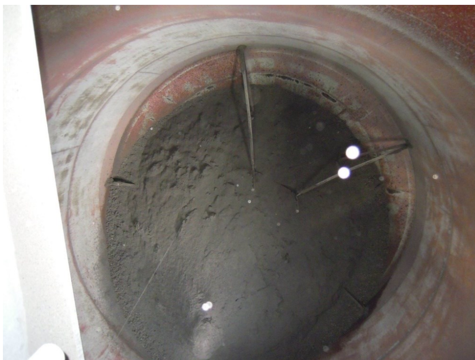
Obr. 5.6. Zásobník odvodněné strusky s doodvodňovacími svíčkami [16]
