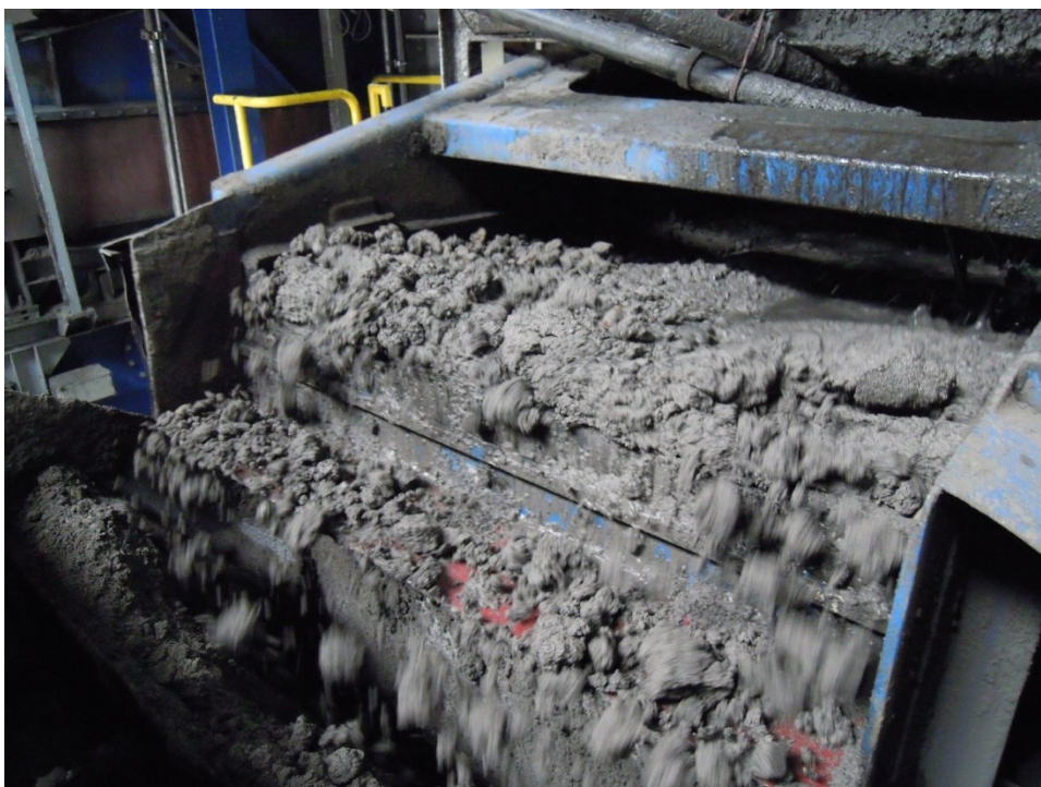
Obr. 5.5. Výnos odvodněné strusky z třídiče na pás [16]
