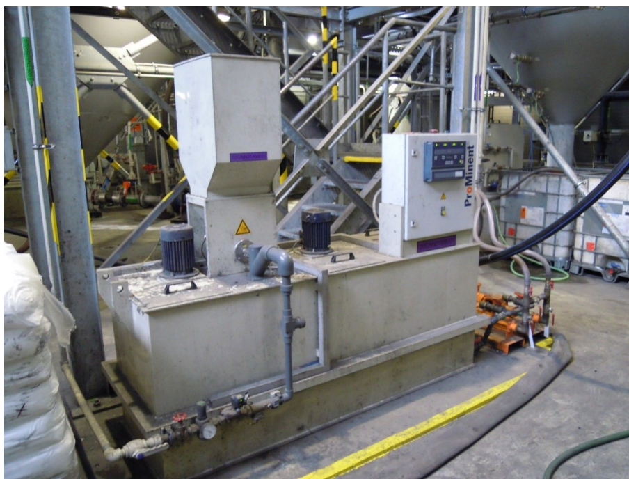
Obr. 6.2. Dávkovací stanice flokulantu SOS EMĚ [16]
