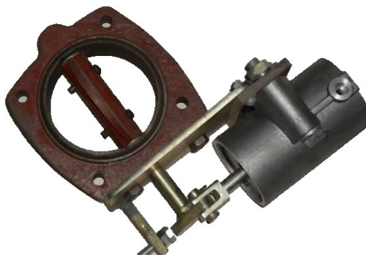
obr. 1 – Příklad výfukové brzdy (klapky) [13]
