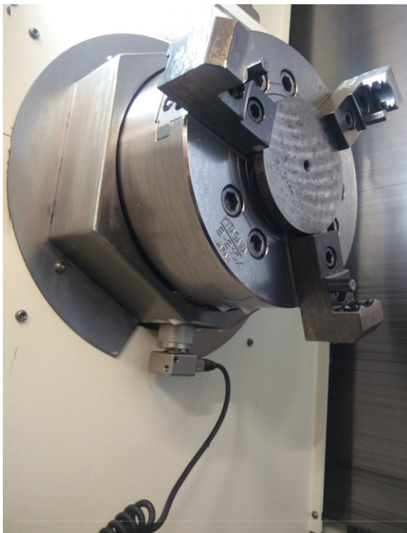
Obr. 13 Použití triaxiálního snímače A115-1A [autor]
