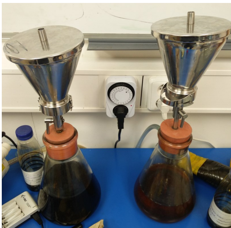
Obr. 21 Zachycení mechanických nečistot – ultrafiltr 0,8 \mu\text{m} [autor]
