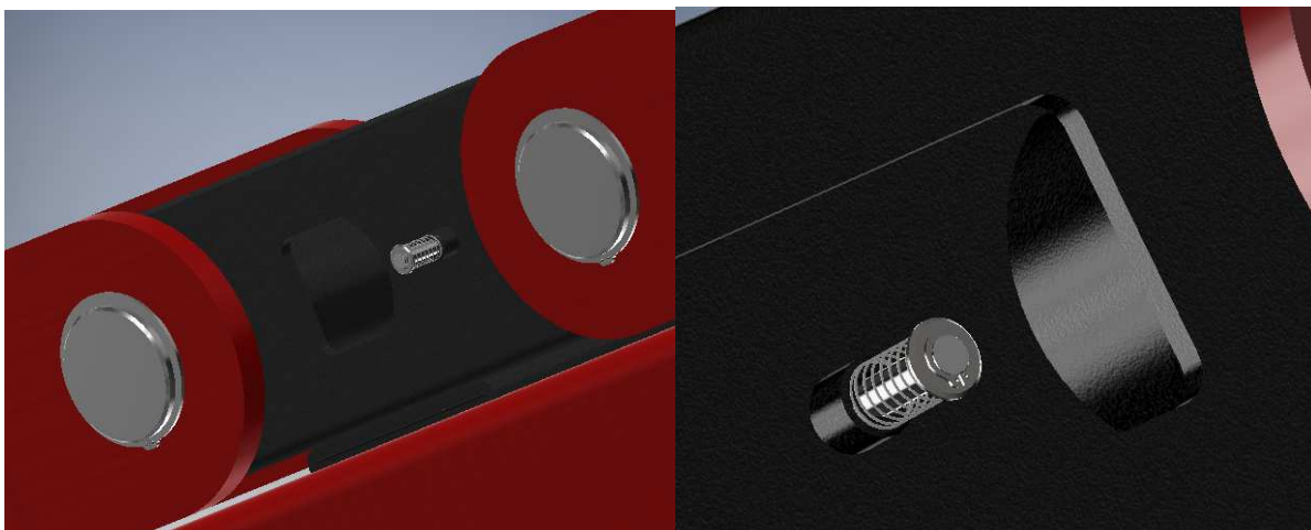
Obr. 5.9. – 3D schéma zajištění ramenou Obr. 5.10. – 3D schéma zajištění pružiny
