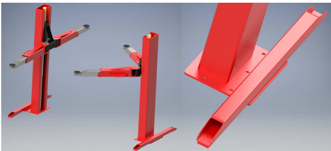
Obr. 5.1. – 3D schéma ustavení zvedáku Obr. 5.2. – 3D schéma podpory sloupu
