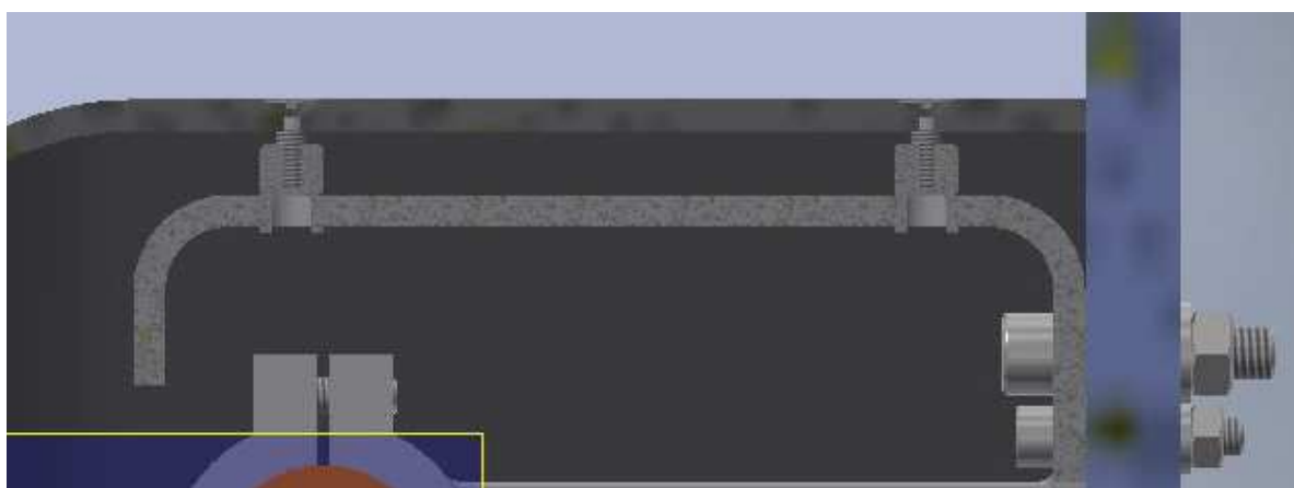
Obr. 56. Přišroubování krytu k profilu pomocí klecové matice.
