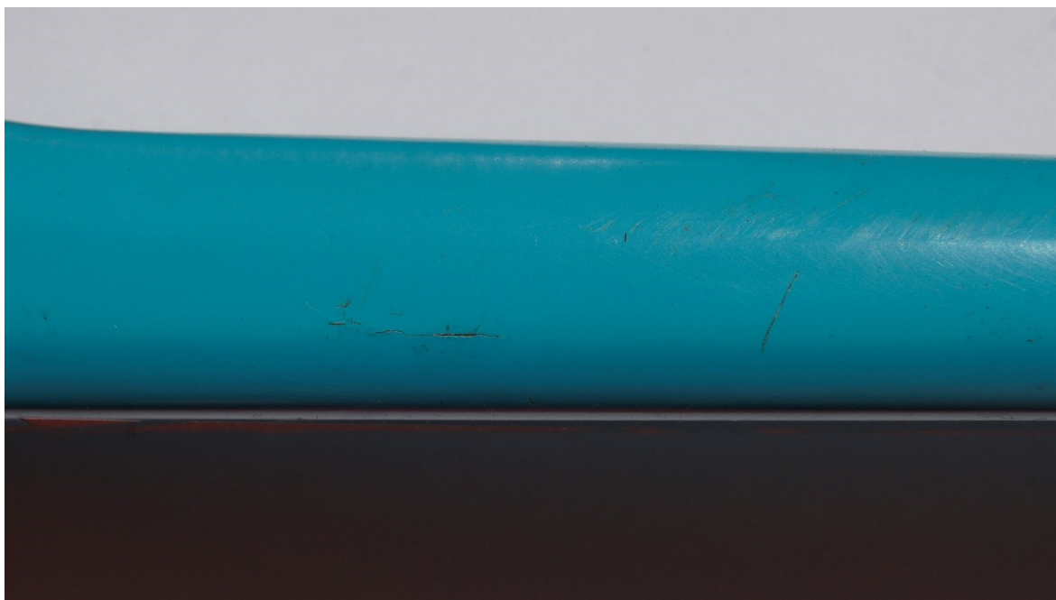
Obrázek 6.1 – poškození rámu následkem pádu či nárazu
