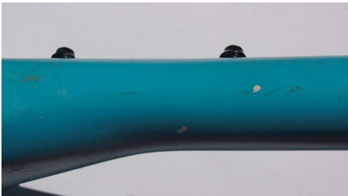
Obrázek 6.2 – Stopy po pádu nebo nešetrném zacházení
