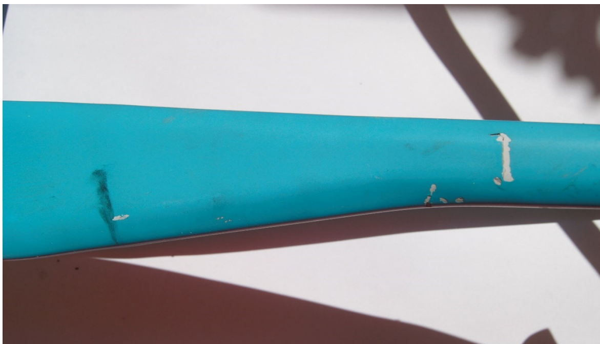
Stopy po pádu na spodní trubce zadní stavby
