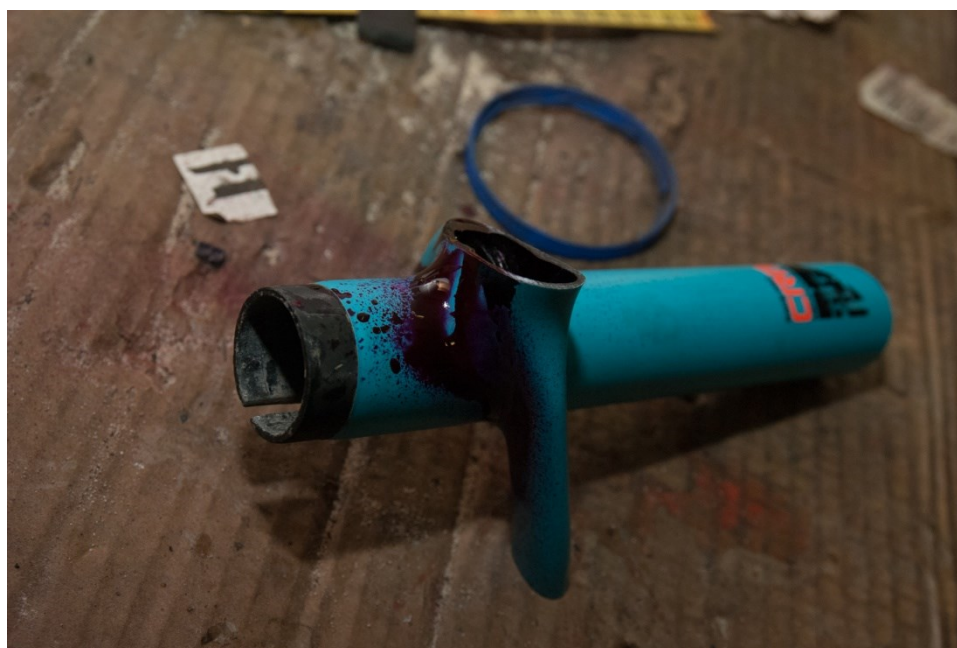
Obrázek 4.1 – Aplikace penetrační látky
