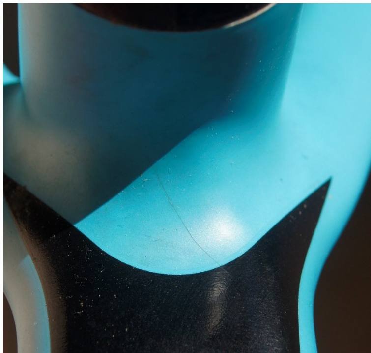
Obrázek 6.3 – Vada ve tvarově složitém místě
