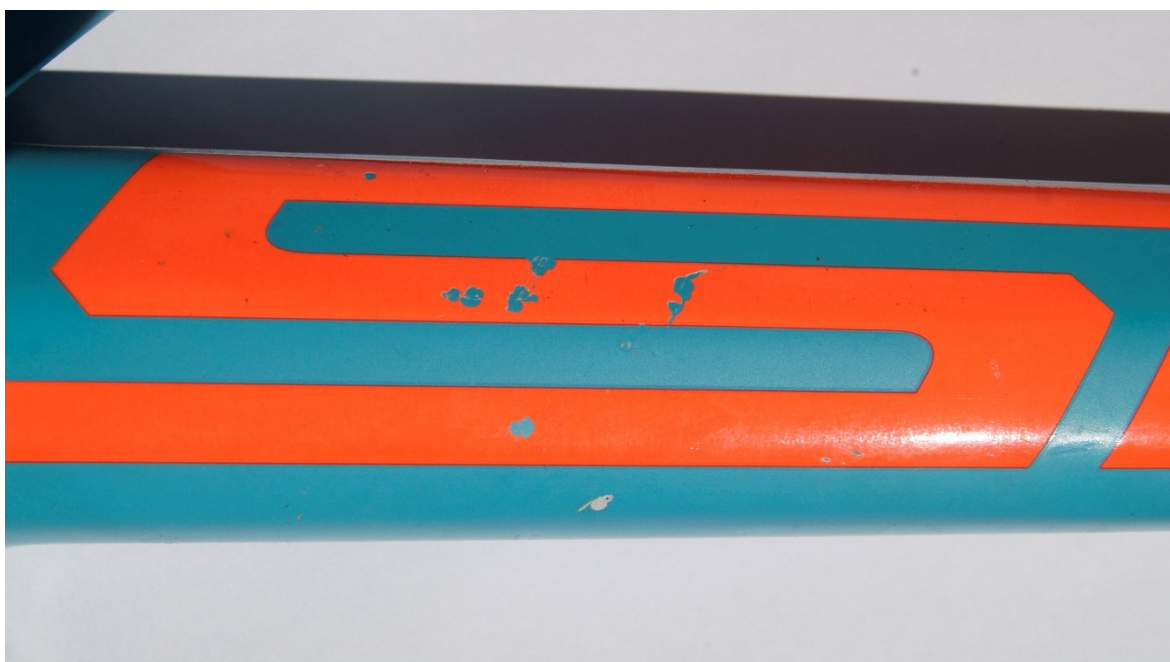
Stopy po pádu na boku spodní rámové trubky
