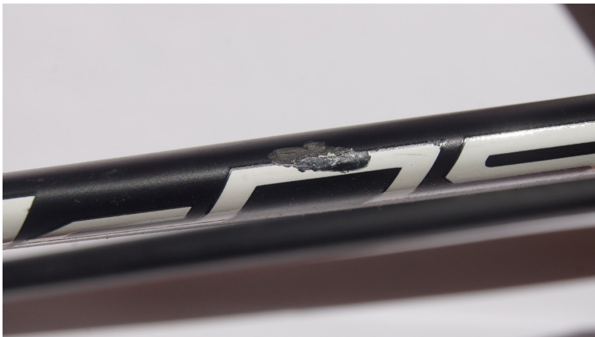
Poškození na horní trubce zadní stavby – následek pádu nebo nárazu
