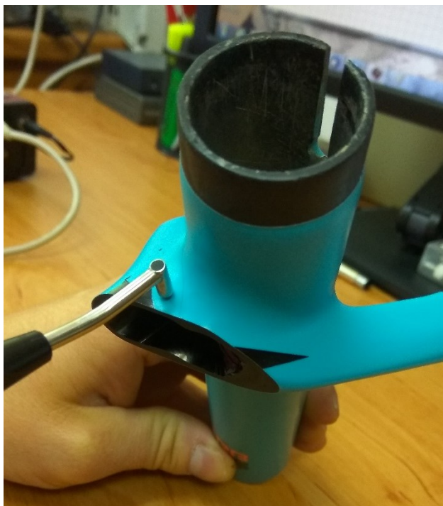
Obrázek 5.16 – Měření místa s prasklinou
