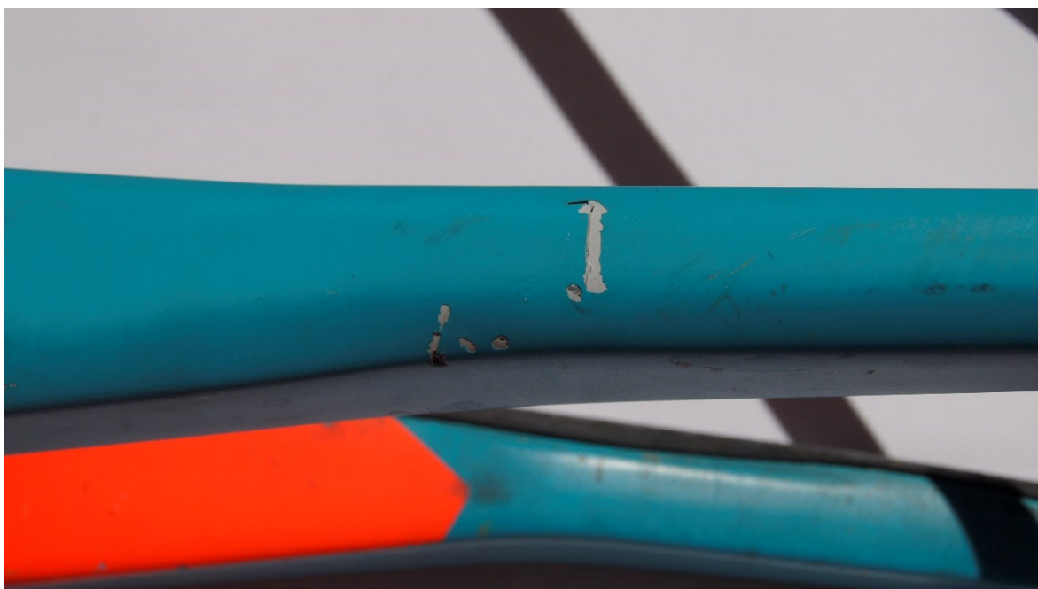
Detailnější pohled na poškození zadní stavby
