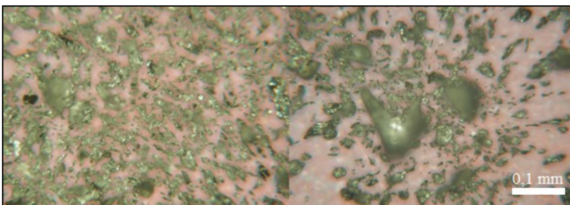
Obrázek 16 - Mikroskopický pohled na zinkový prach VP zvětšený 100x u vzorku 1, 2
