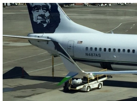
Obrázek 2- Tripod-jack na B737-900ER (16)
