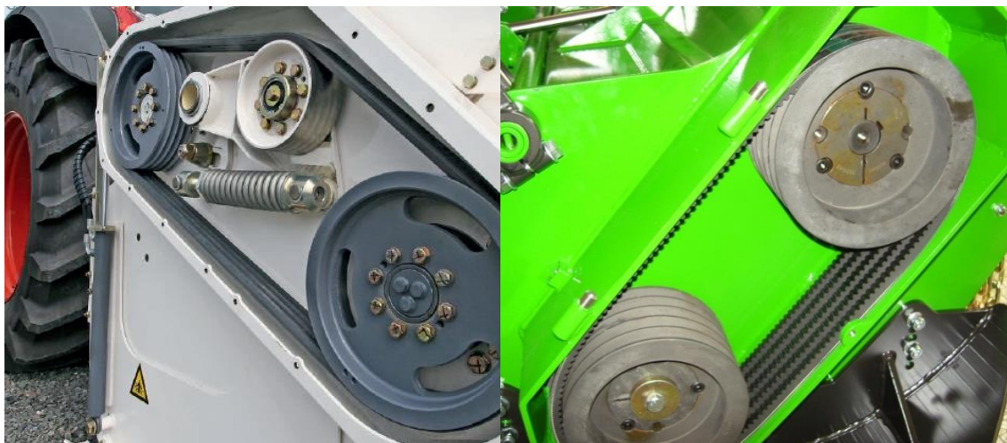
Obrázek 3.4 Provedení řemenového převodu: vlevo s klínovými řemeny, vpravo s ozubenými řemeny [12]
