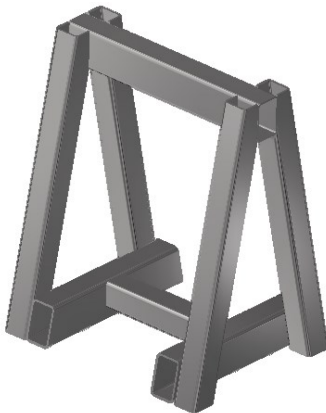
Obrázek 8: Jeklová konstrukce původního lisu
