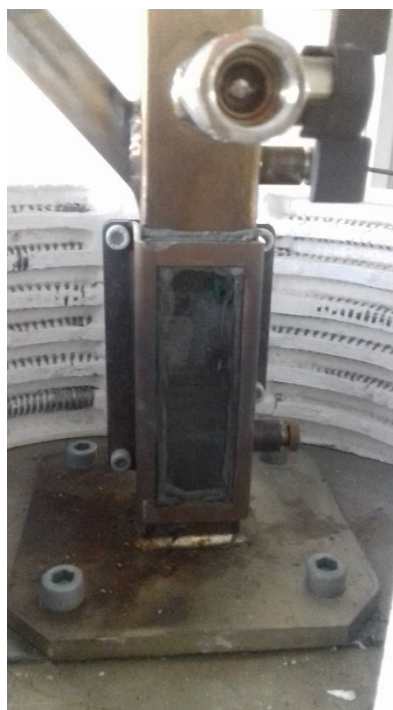
Obr. 7.18 Otvor ve spodní části reaktoru pro vizuální kontrolu
