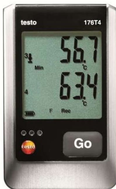
Obr. 7.16 4-kanálový datalogger Testo 176 T4 [19]
