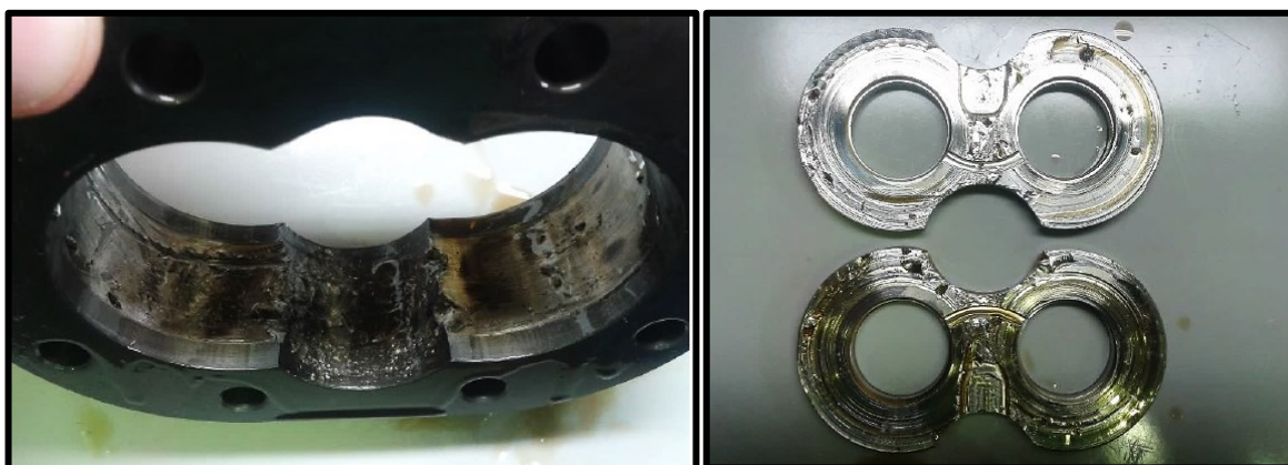
Obr. 1.1 - Opotřebení vlivem provozu čerpadla v režimu kavitace [7]
