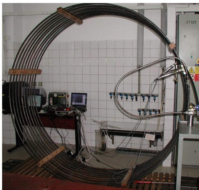
Obr. 6.7 Foto svitku hydraulického potrubí [16]
