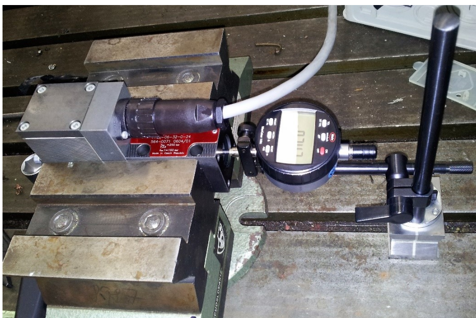
Obr. 5.5 Fotografie měření zdvihu šoupátka rozváděče
