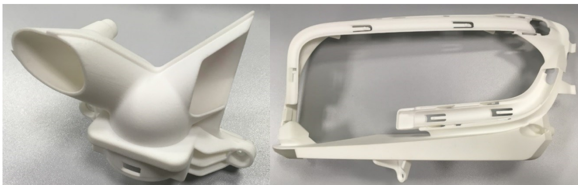
Obrázek 4: 3D tisk dílů pro světlomet - ověření designu a funkčnosti dílů
