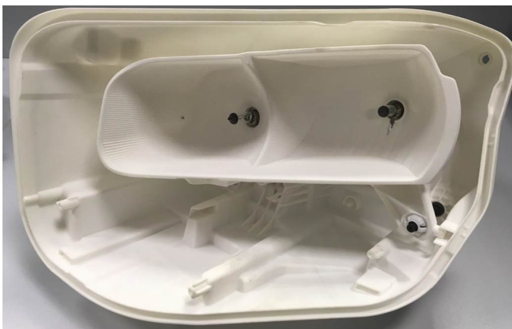
Obrázek 5: 3D tisk dílů pro světlomet - ověření designu montáže
