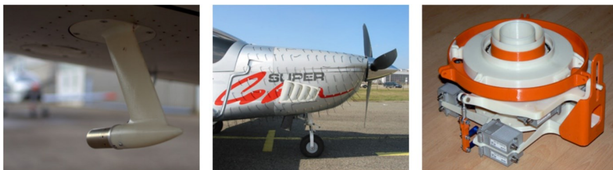
Obrázek 13: Evector - příklady využití 3D tisku - držák pitostatické trubice, výstupní mřížka, funkční prototyp rotorové hlavy (30)
