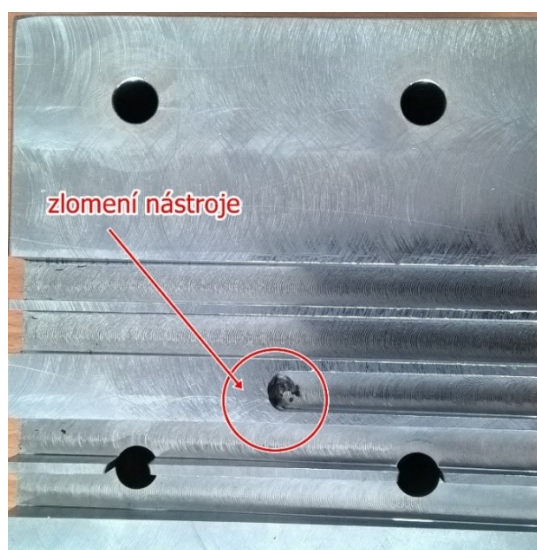
Obrázek č. 23 – Drážky po procesu frézování druhého kusu
