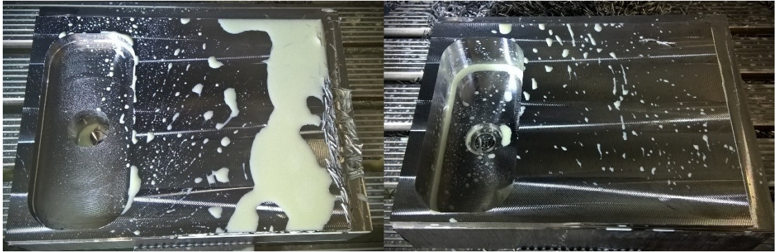
Obrázek 45 – Zkušební řez a řez na plnou axiální hloubku nástrojem Iscar D_c 12 strategií opravdová spirála
