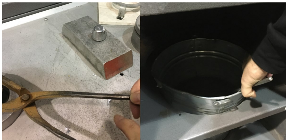
Obrázek 30 Vyjmutí a ochlazení vzorku slitiny
