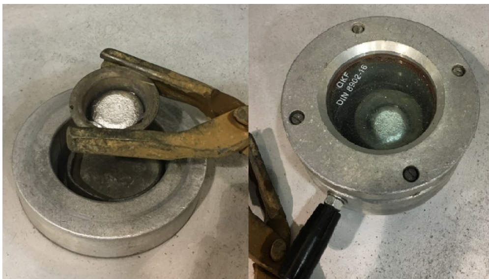
Obrázek 28 Umístění vzorku do vakuové jednotky
