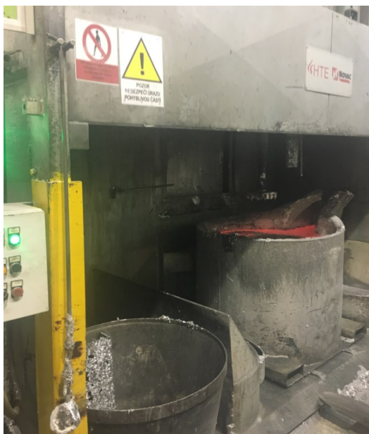
Obrázek 25 Umístění pánve do jednotky odplynění
