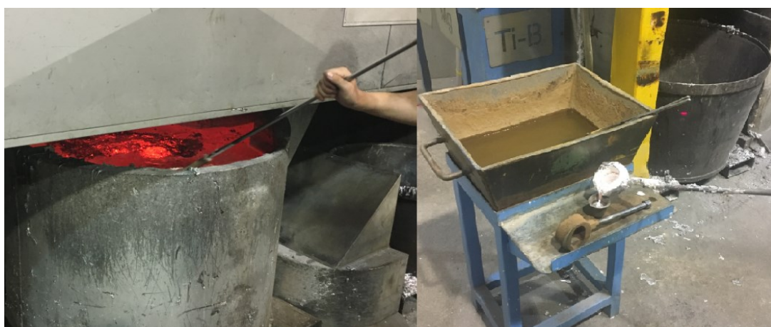
Obrázek 27 Odebrání vzorku pro vyhodnocení naplynění
