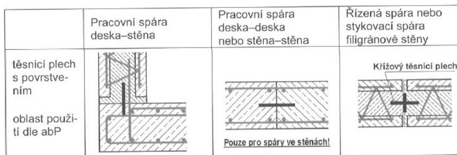
Obrázek 1: Těsnění pracovních spár (1)
