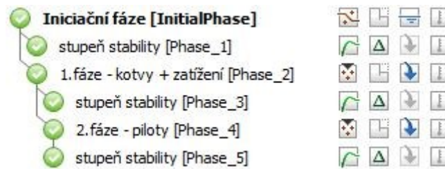
Obrázek 26: Návrh výpočetních kroků pro stabilizaci mikropilotami.
