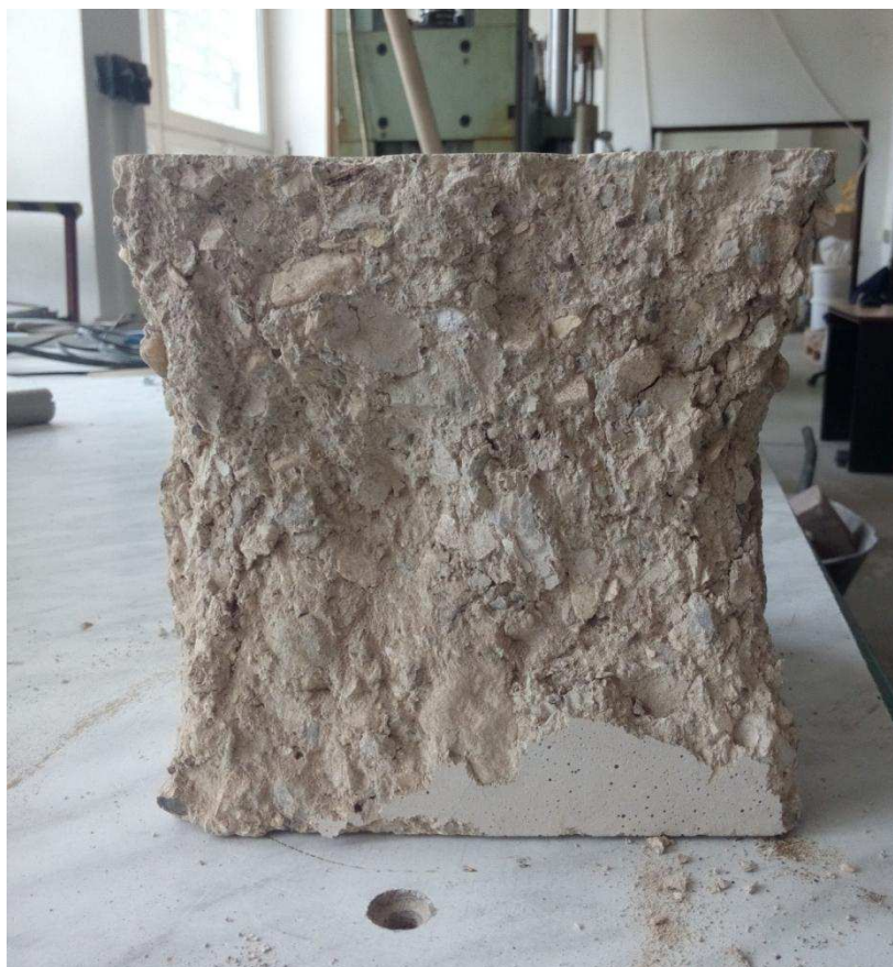
Obrázek 22: Zkušební krychle po zkoušce pevnosti v tlaku - receptura č. 2
