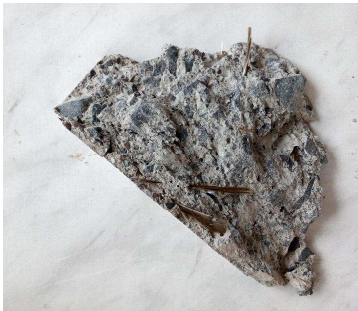
Obrázek 20: Detail části zkušební krychle, kde jsou viditelné čedičové vlákna- receptura č. 1
