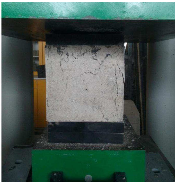
Obrázek 9: Zkušební krychle zkoušená na pevnost v tlaku
